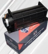
GNL-FB9B(220V)-02 • BRB - 风机 • Rotate Speed:1700(rpm) - 转速 • Air Volume:8.5(m³/min) - 风量 • Power:25(w) - 功率 • Install size:380x90(mm) - 安装尺寸
